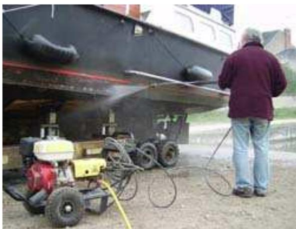
Photo 3 : Nettoyage à haute pression de la carène d'un bateau
