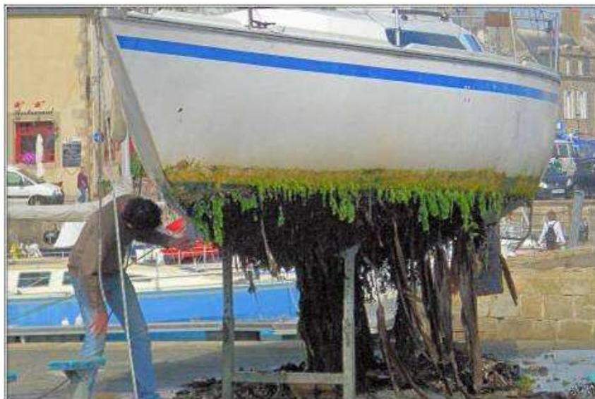
Photo 1 : Fouling (salissure) sur la carène d'un voilier
