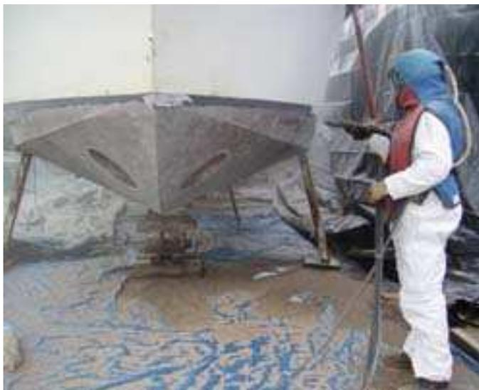
Photo 5 : Sablage à sec d'une coque
