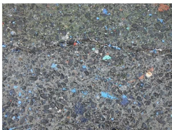
Photo 4 : Macro-particules de peinture déposées au sol après un lavage à haute pression
