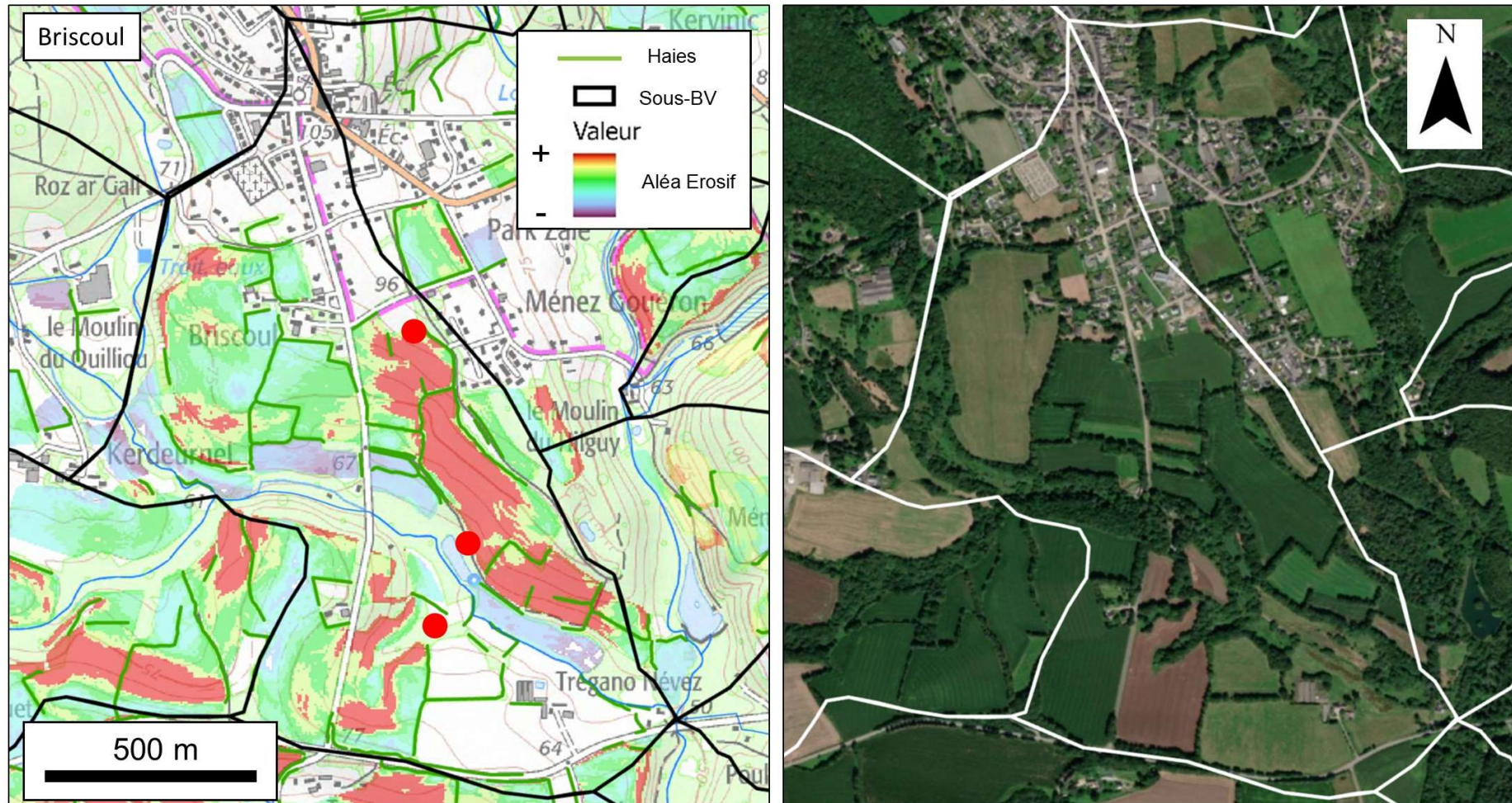
Figure 37 : Bassin versant de Briscoul. Représentation de l'aléa érosif et photo aérienne
