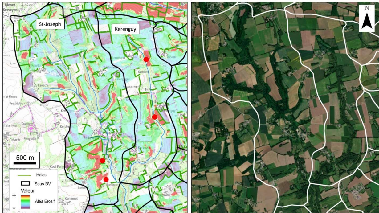
Figure 44 : Bassins versants de St-Joseph et de Kerenguy. Représentation de l'aléa érosif et photo aérienne
